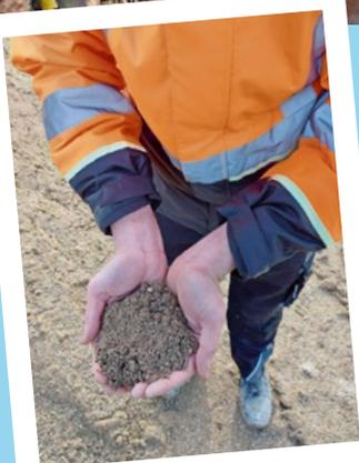
Das gebrochene Material wird im Anschluss noch gesiebt und in verschiedene Körnungen unterteilt.
